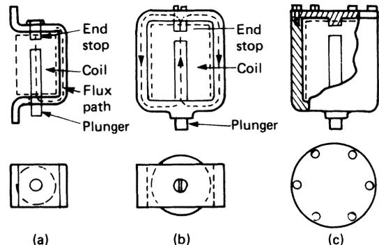
Figure 20.4 D.c. actuators
