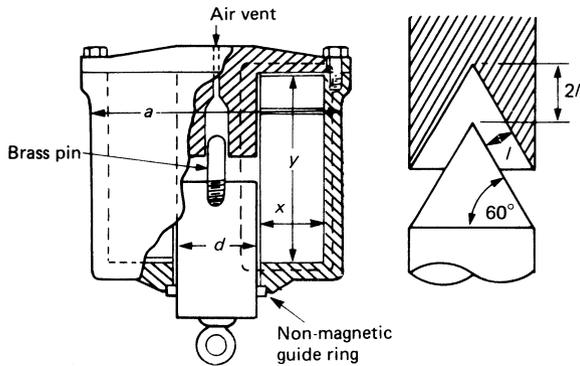
Figure 20.5 Iron clad 'pot' actuator
